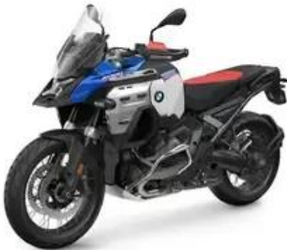
水平对置双缸引擎 1300cc 145匹马力
