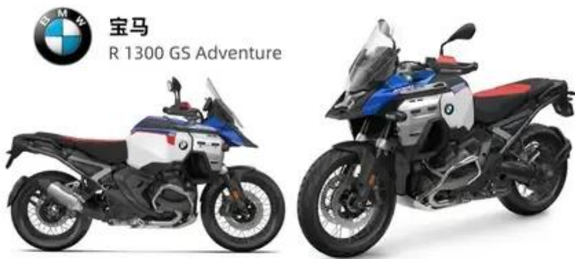
水平对置双缸引擎 1300cc 145匹马力
