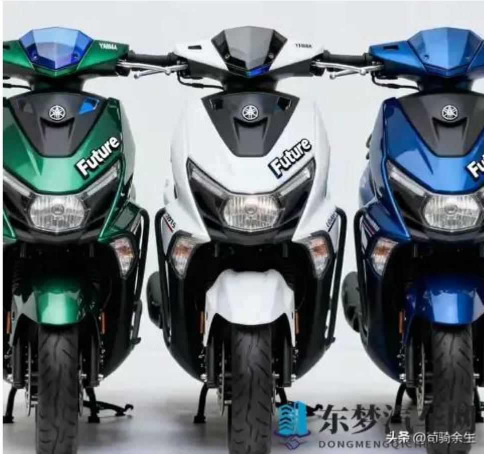
虽然参数上不算顶尖，甚至略逊于部分国产同排量机型，但雅马哈的调校功底让它成为实用型选手。实测百公里油耗稳定在2L左右，搭配6.1L的油箱，续航轻松突破250公里，日常通勤、周末周边溜车完全能满足，不用频繁加油。更关键的是它的皮实耐造，简单的机械结构降低了故障概率，小毛病少，后期维修保养成本很低，卤素大灯的更换成本远低于LED，常规保养也只需要换油、换空滤，长期使用下来能省下不少开支。
