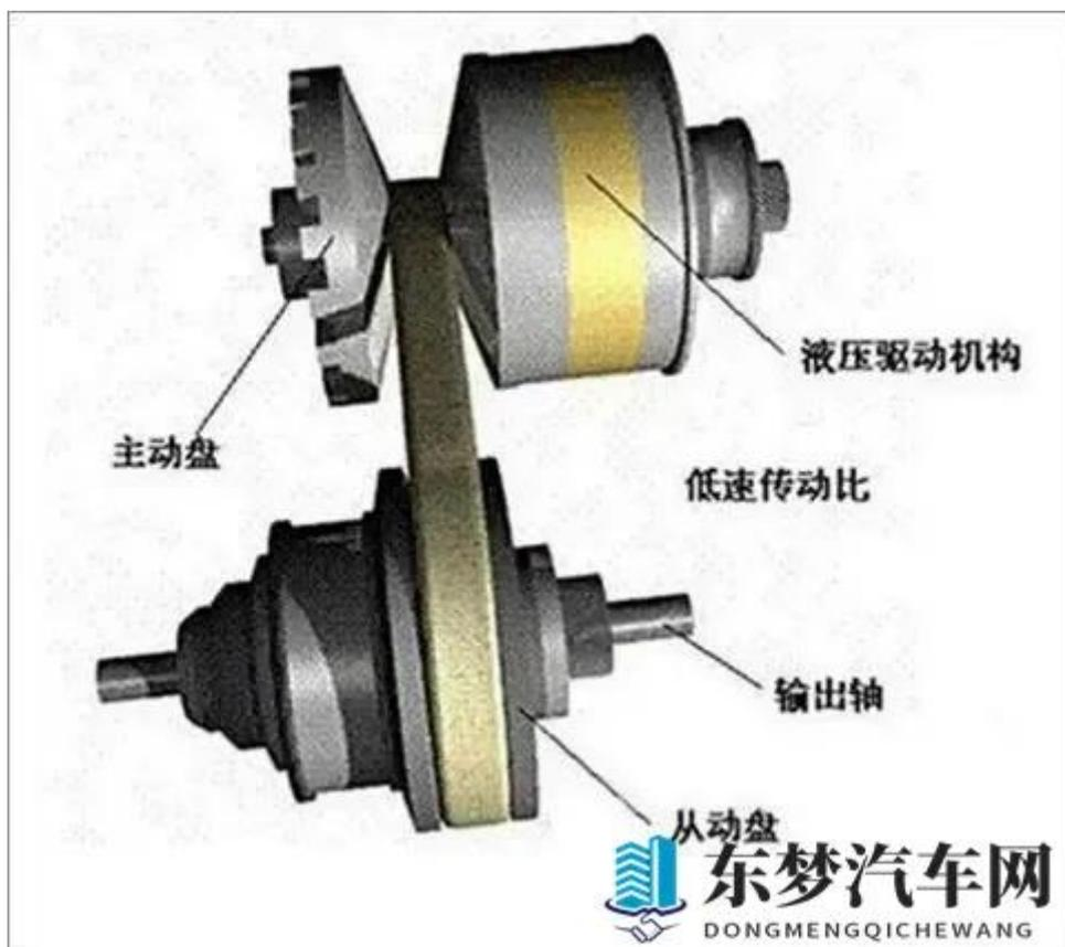
真相是：正常行驶下，现代CVT根本不会打滑。它的传动核心是推片式钢带和锥轮，靠的是巨大的夹紧力实现的静摩擦，不是你以为的“滑来滑去”。其实只要是钢带打滑，就表示CVT变速箱已经出现了故障，而一旦打滑，就会导致锥轮和钢带严重磨损，甚至钢带碎裂，其实换个角度想想，如果真那么容易打滑，厂家敢拿出来卖吗？早赔死了。你觉得“打滑”，更多是急加速时发动机光吼不走的特性给你的错觉。而这是因为CVT变速箱在通过电控液压调整锥轮速比。
